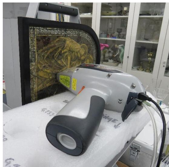
**Abb. 1:** Der Objektgeometrie angepasster Messaufbau bei der Analyse der Gläser des MAKK, hier: Eine vermutet venezianische Karaffe (links, Inv. Nr. F 59) sowie das amelierte Hinterglasbild „Maria mit Kind“ (rechts, Inv. Nr. M 290). © MAKK/K.T.Friedrich
